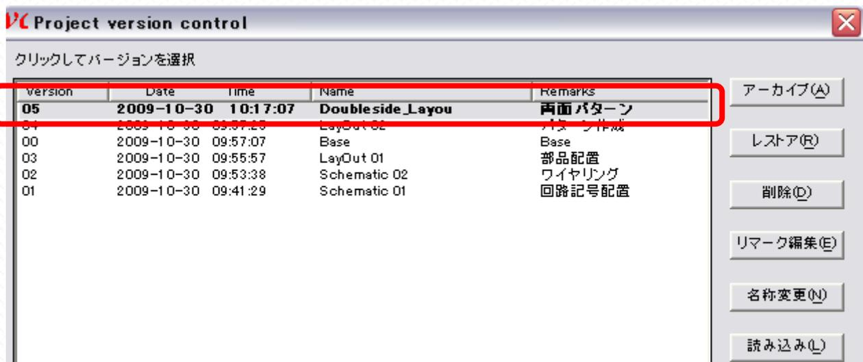
両面パターン作成後、プロジェクトバージョンコントロールでは編集中のバージョンと、選択したバージョンを“比較”ボタンで違いを見る事ができます。
